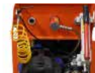
Hydraulisk pumpe med trykkventil
