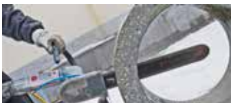
Beluga SXM som drivkilde for Espada 400 kjedesag med diamantkjede.
