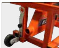
Støvuttakslens for tilkobling av støvsuger
