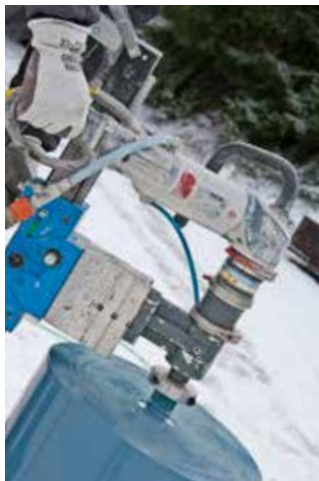
Beluga SXM drivkilde med adapter og planet gear og drillhode for kjernebor
