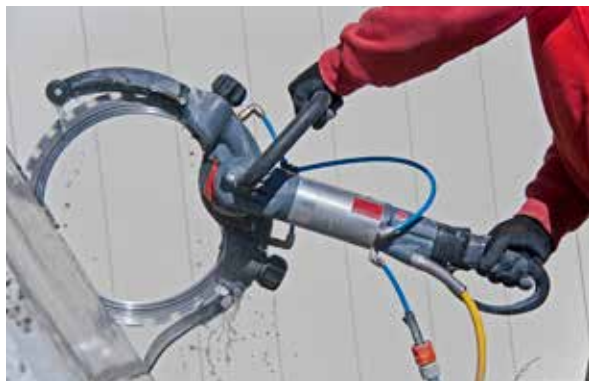
Beluga SXM drivkilde med påmontert ringsagmodul.
