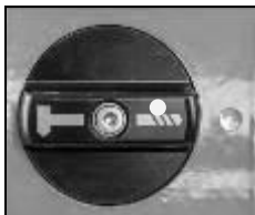
Boor symbool op markering - boren zonder zachte klopfunctie
