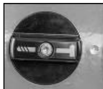
Hammersymbol på mærket - boring med milde slag
