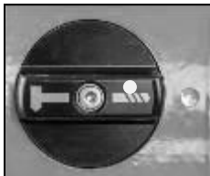
Boresymbol på mærket - boring uden milde slag
