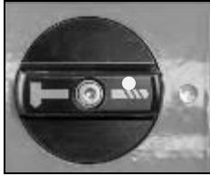
Symbol Bohrer auf Markierung - Bohren ohne Softschlag
